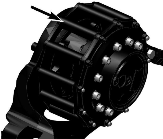
Рисунок 1 Система привода с одинарным выступом
